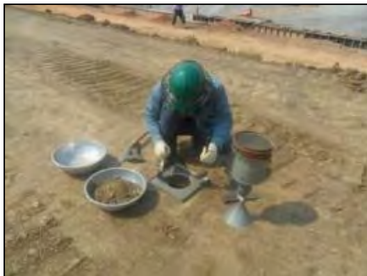
การทดสอบค่าการบดอัดบริเวณขอบบ่อ
