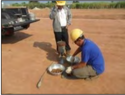
การทดสอบค่าการบดอัดที่ระดับพื้นผิวของฐานหลุมผลิตก่อนการ ขุดบ่อกักเก็บเศษดินเศษหินจากการเจาะช่วงบน
